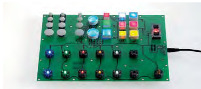
Obere Hälfte: RAFI Kurzhubtaster RACON 8 /12, MICON 5, RF 15/19, Kurzhub-Netzschalter KN 19 Untere Hälfte RAFIX FS Schaltelemente, teilweise mit 3 mm THT-LED
